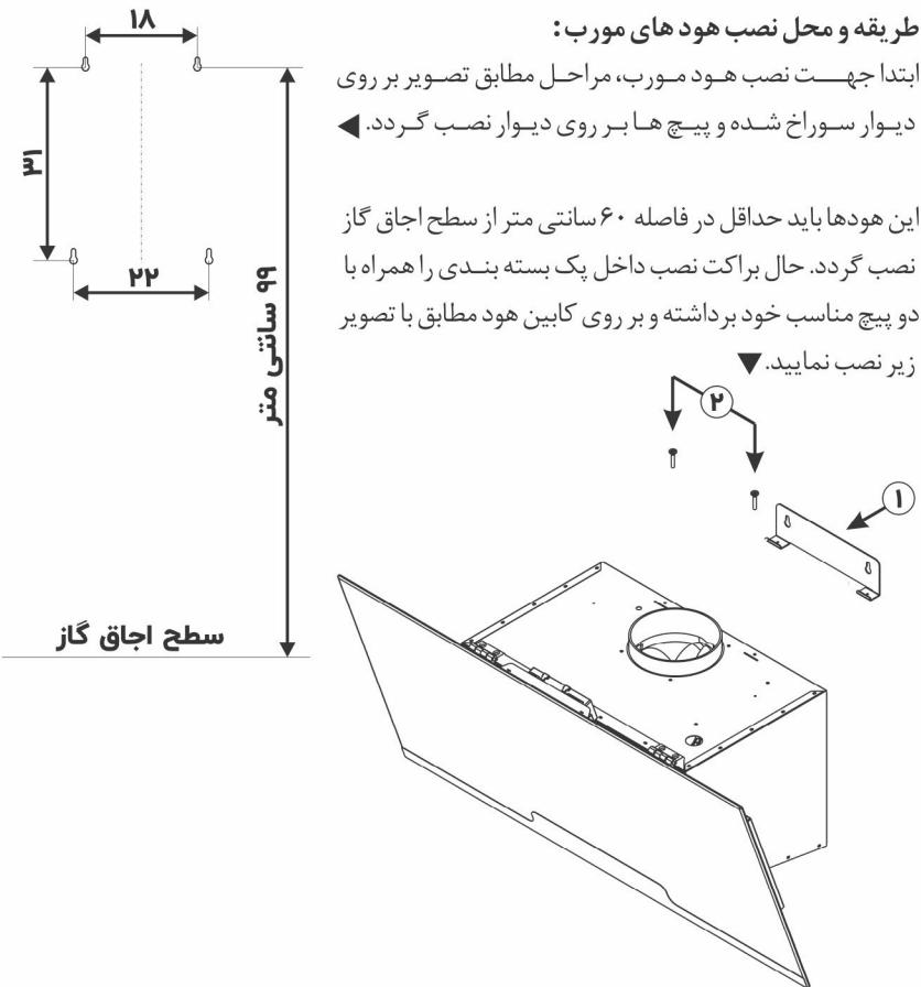
و در مرحله آخر، هوود بر روی پیچ هایی که از قبل آماده شده بر روی دیوار نصب نمایید.
