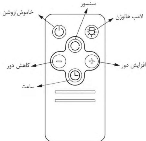
برای تنظیمات ساعت روی نمایشگر هود می بایست با استفاده از ریموت کنترل پنل لمسی اقدام به تنظیم ساعت نمایید به نحوی که با زنگه داشتن کلید ساعت وارد تنظیمات ساعت شده و حالا اقدام به تنظیم می نماییم.
